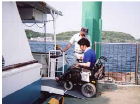
乗船の様子。スロープはデッキの床の穴に設置する
