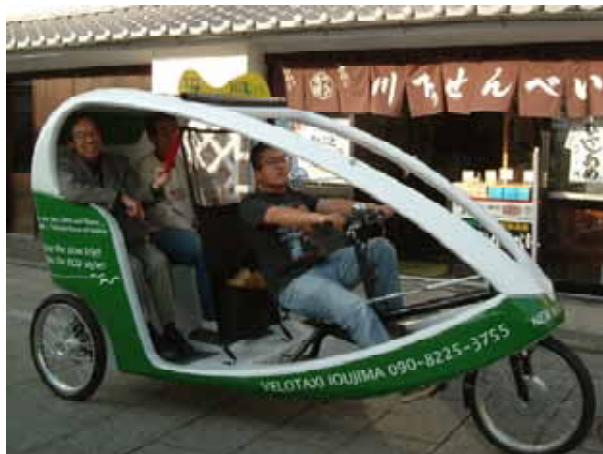
三輪の自転車に樹脂製のボディ。 後部座席には男性の大人二人が乗れる。
