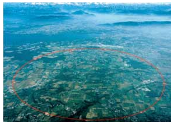
赤い円が空から見たCERNのLHC加速器のトンネル。実際には地下100mにあり見えない。(KEK HPより)
