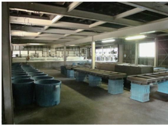
工場内の全景、横に並べられた青いポリタンクで本葛を沈殿させる
