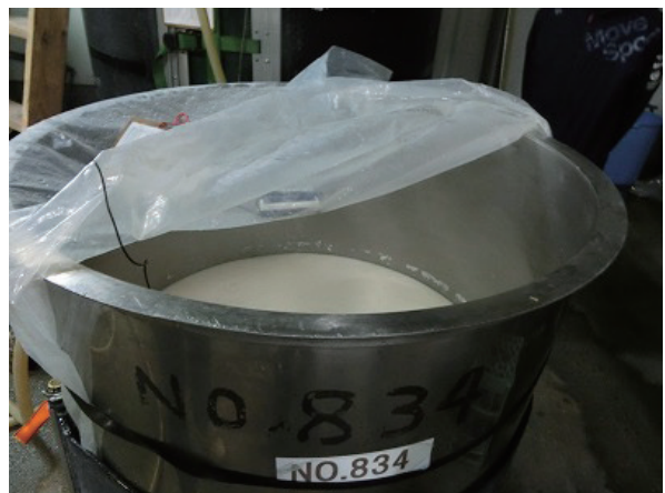
蒸し米に水、麹、酵母を加え酒母造り
