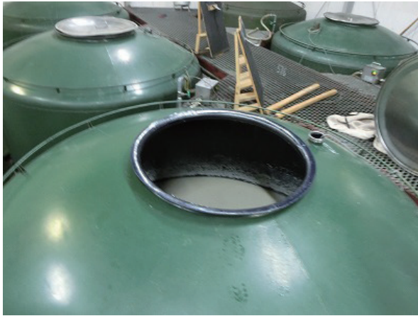
酒母にさらに蒸米、麴、水を加えて原酒となる（もろみ造りのタンク）
