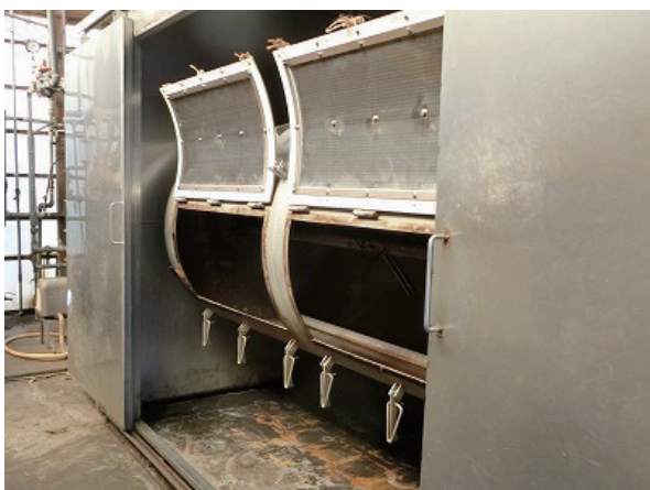
製麴機～蒸米と麴を攪拌する機械
