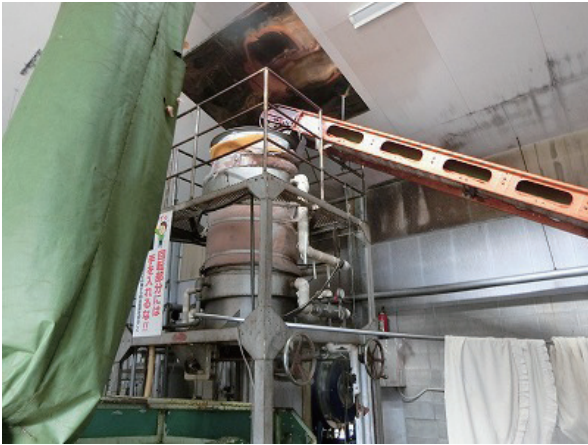
洗米をベルトコンベヤーで蒸器に投入
