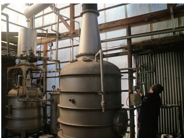
600 リットルの蒸留器、この蒸留器1基で多品種の焼酎を造っている。右下に見える円形の入口に入り、毎回、中を洗浄している
