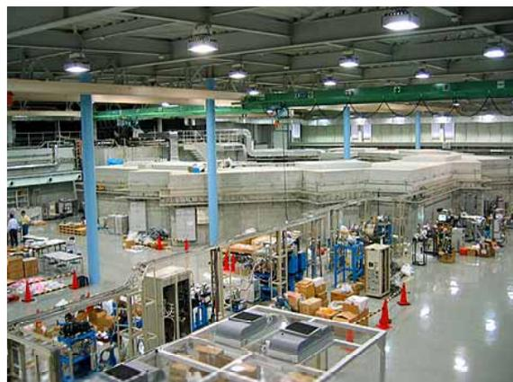
実験フロアー内部、コンクリートで遮蔽された蓄積リングから手前に伸びているのがビームライン(HPより)
